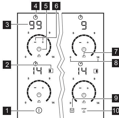
K zobrazení ovládacího panelu zapněte spotřebič pomocí ①.
