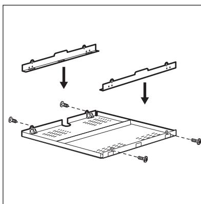
Po zamontowaniu kasety ochronnej (wyposażenie dodatkowe), nie ma konieczności pozostawienia 2 mm przestrzeni wentylacyjnej z przodu, jak i montażu przegrody zabezpieczającej bezpośrednio pod płytą grzejną. Wyposażenie dodatkowe w postaci kasety ochronnej może być niedostępne w niektórych krajach. W celu uzyskania dodatkowych informacji należy skontaktować się z miejscowym dostawcą.
