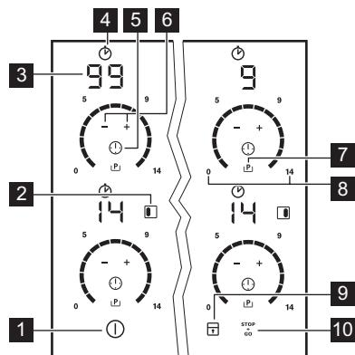
Pour afficher le bandeau de commande, allumez l'appareil en appuyant sur ①.
