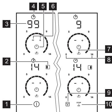
Aby wyświetlić panel sterowania, należy włączyć urządzenie za pomocą ①.
